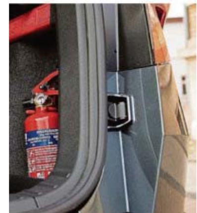
Ein Auto-Feuerlöscher kann zum Beispiel an der Seite des Kofferraums montiert werden.
