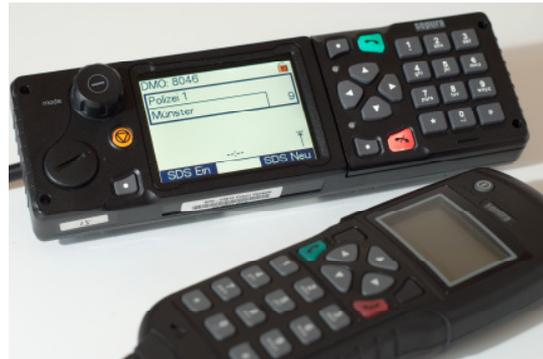
Abbildung Bediengerät zum SEPURA SRG 3900 und Bedienhandapparat
