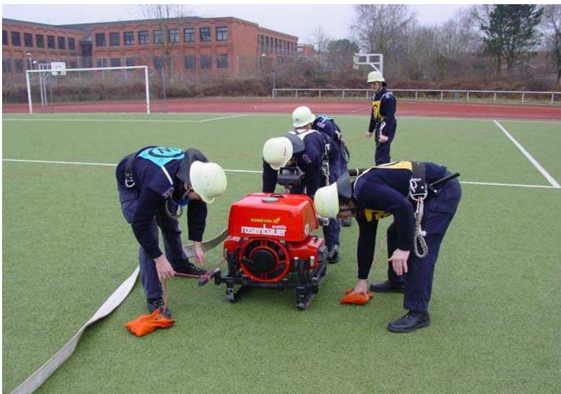
*Bild 27: Richtiges Befestigen der Saugschlauchleine durch den Wassertruppführer und Ablegen des Ventilleinenbeutels durch den Schlauchtruppführer*
