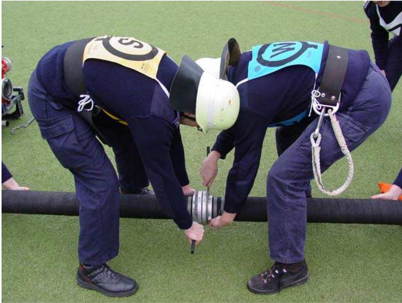
*Bild 20: Kuppeln der Saugschläuche durch Wassertrupp- und Schlauchtrupfführer mit angesetztem Kupplungsschlüssel*
