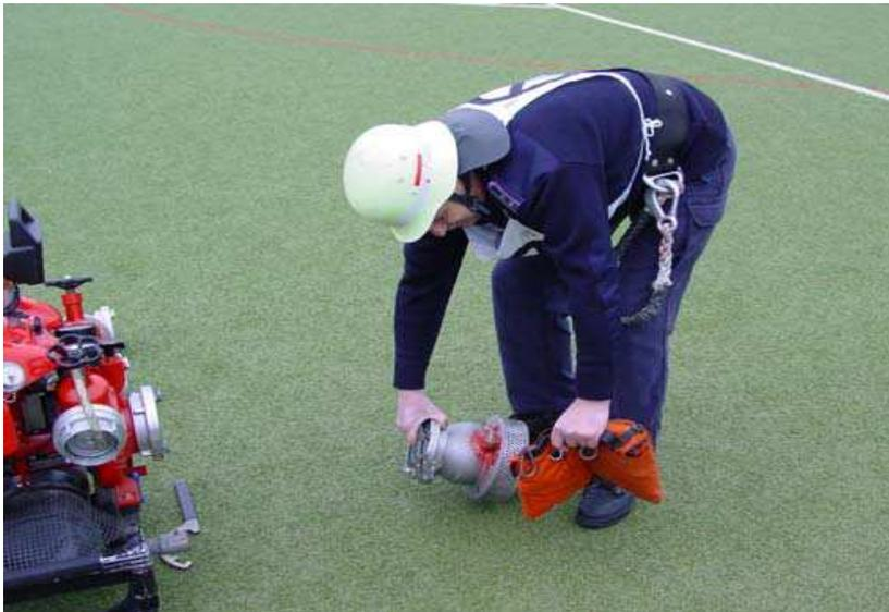
*Bild 8: Aufnehmen der Leinenbeutel, der Kupplungsschlüssel und des Saugkorbes durch den Maschinisten*
