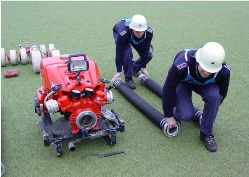
*Bild 9: Aufnehmen der Saugschläuche durch den Wassertrupp*
