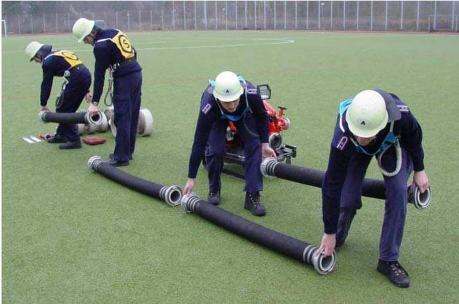
*Bild 11: Auslegen der Saugschläuche durch Wassertrupp und Schlauchtrupp*
