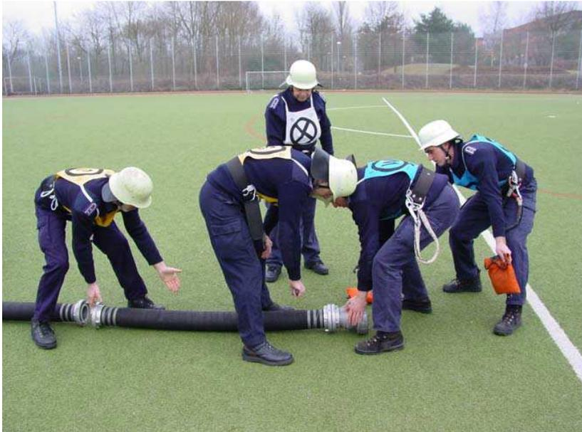
Bild 16: Kuppeln des Saugkorbes durch Wassertrupp- und Schlauchtruppführer
