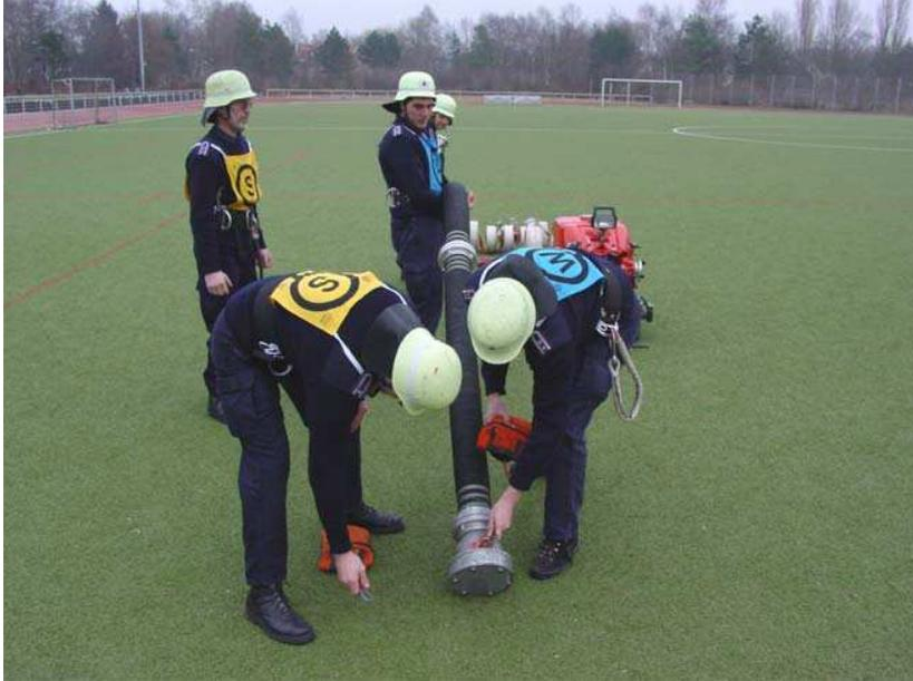
*Bild 21: Anlegen der Saugschlauchleine durch Wassertruppführer und Anlegen der Ventilleine durch Schlauchtruppführer*
