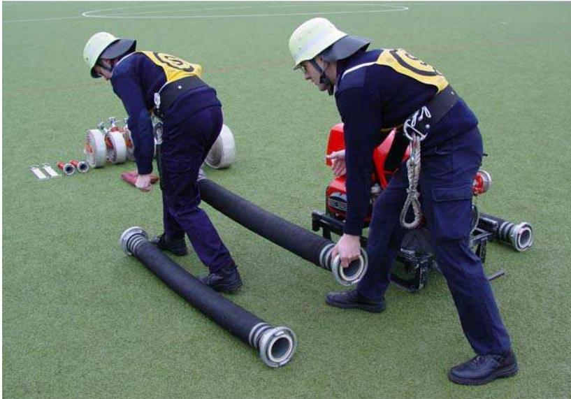
*Bild 13: Auslegen der Saugschläuche durch den Schlauchtrupp*
