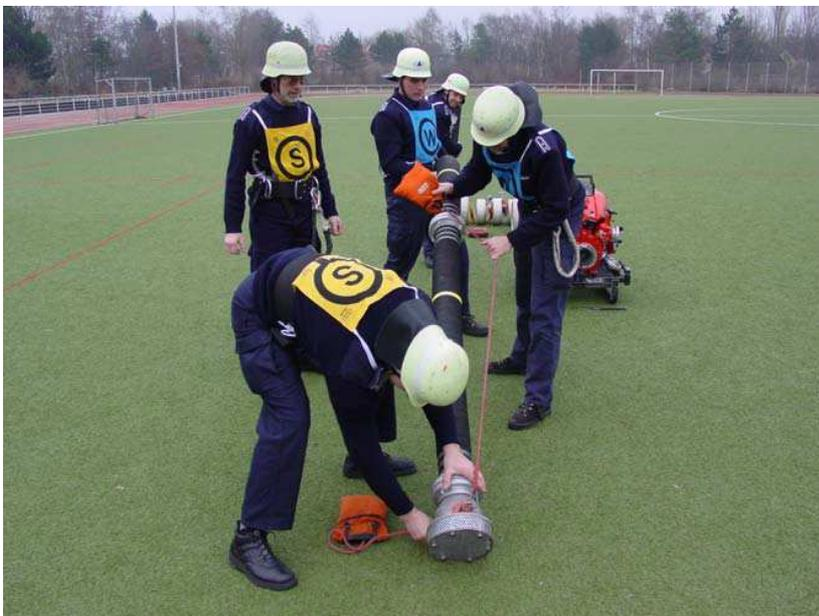
*Bild 22: Richtiger Leinenschlag vor jeder Saugschlauchkupplung*
