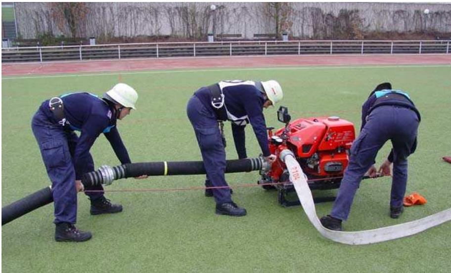
*Bild 26: Maschinist und Wassertruppmann beim Ankuppeln der Saugschlauchleitung an die TS*
